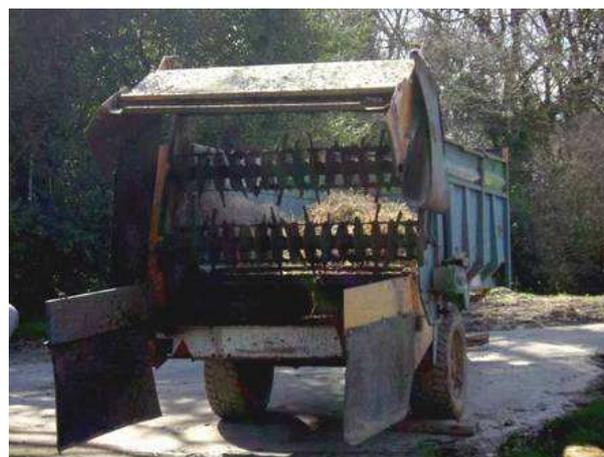
Photographie 5 : Epandeur à fumier avec table d'épandage et déflecteurs pour réaliser des andains
