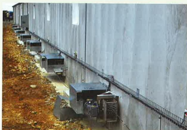
▲ **Les racleurs sont entraînés par des treuils inversés** qui enroulent les câbles Deltex en fibres synthétiques. Cette matière semble mieux résister que les câbles métalliques.
